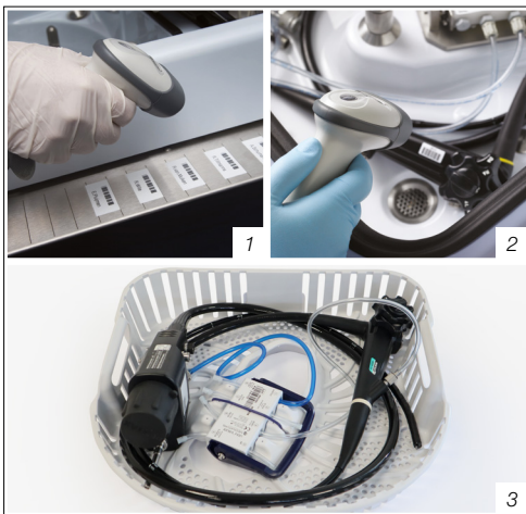
1) Stregkodescanner. Indlæsning af operatør m.m. 2) Stregkodescanner. Indlæsning af skoptype m.m. 3) Kassettesystem som følger skopet i hele processen
